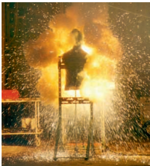
Bild 5.1: Testpuppe mit einer Jacke, die einem Lichtbogen im Box-Text ausgesetzt wurde
