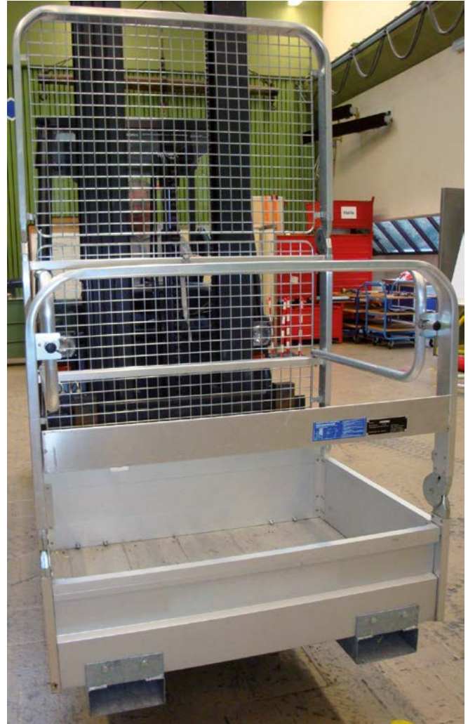
Bild 6-2: Beispiel einer Arbeitsbühne für Gabelstapler
