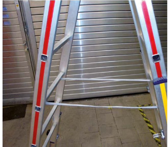
Bild 6-1: Fest angebrachte und fest sitzende Spreizsicherung und verstellbare Länge der Leiterfüße, um Unebenheiten der Standfläche ausgleichen zu können
