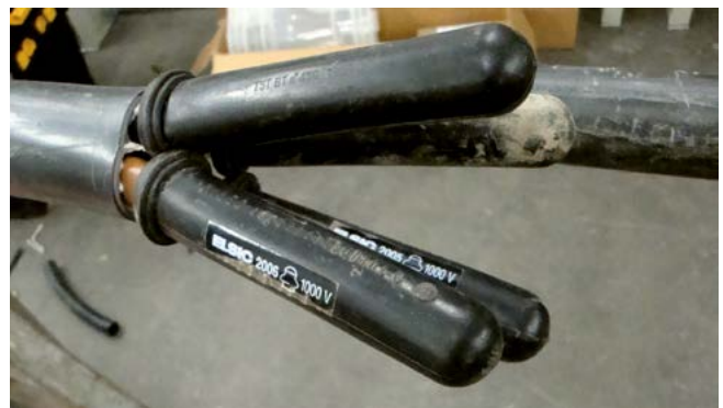
Bild 5-5: Isolierkappen zum Abdecken von Isolatoren
